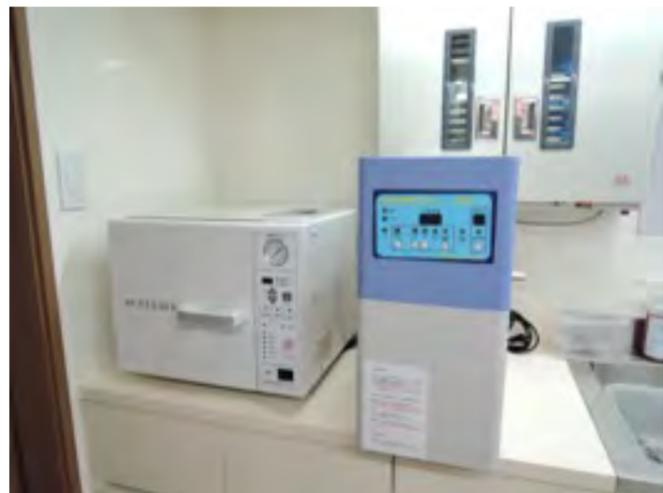
⑥ ホルホープデンタルはホルマリン（ホルムアルデヒドの37%水溶液）を利用し、オートクレーブのような高圧加熱滅菌ができないプラスチック等の殺菌が可能です。殺菌後のホルマリンの中和消臭も完全です。
