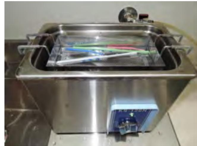
④ 漂白剤に浸けた後にステリパワー液（次亜塩素酸ナトリウム・希塩酸水）にて15分間の超音波洗浄をします。その後水洗・自然乾燥します。
